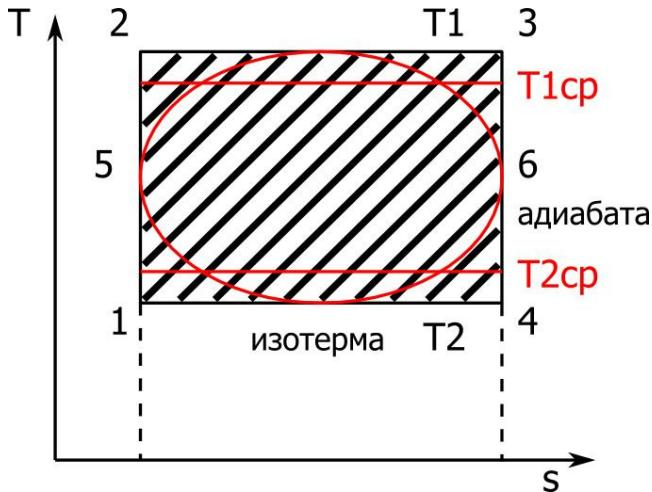
При исследовании обратимых циклов степень совершенства произвольного обратимого цикла определяется тем, насколько термический КПД этого цикла близок к термическому КПД обратимого цикла Карно, осуществляющегося между крайними температурами рассматриваемого цикла.
